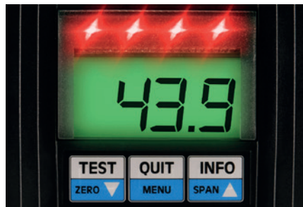
CC28 DA mit Display, Alarm-LEDs und Hupe
