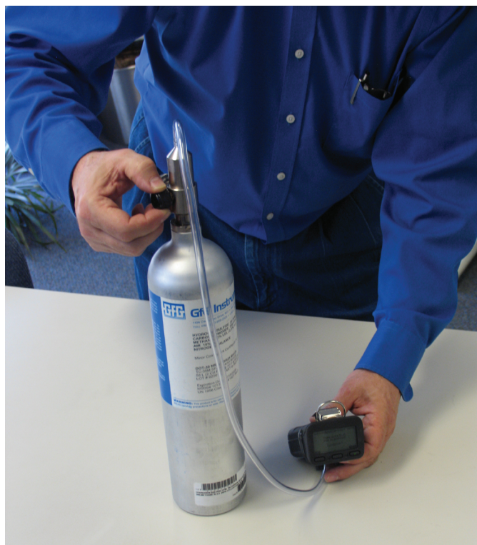
Figura 1: Llevar a cabo una prueba funcional “Bump Test” mediante la exposición del instrumento a gas de prueba toma solo unos cuantos segundos en ser terminada.
